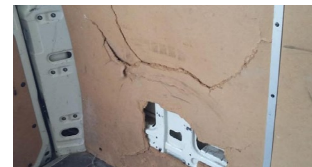
Houten binnenbekleding: Deuken, gescheurd paneel, paneel ontbreekt (exclusief bovenste deurpanelen)
