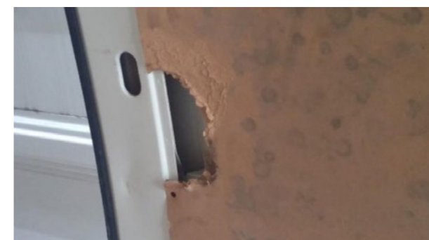
Houten binnenbekleding: Deuken, gescheurd paneel, paneel ontbreekt (exclusief bovenste deurpanelen)
