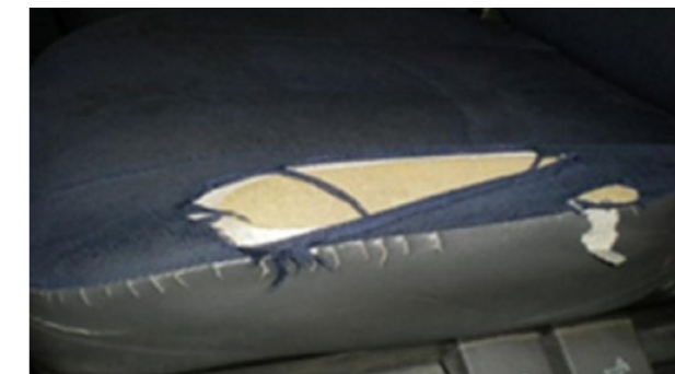
Brandplek > 3 mm, perforatie of scheur in de bekleding, zonder beschadiging van de opvulling
