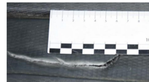
Perforatie van hard kunststof bekleding. Reparatie van hard kunststof bekleding | standaard uurtarief indien esthetisch acceptabel en reparabel
