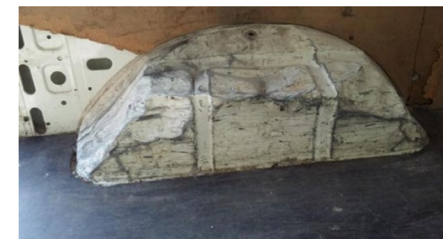
Vervorming aan de binnenzijde: Perforaties, insnijdingen, vervormingen niet economisch verantwoord te repareren. Denaturerende en niet-corrigeerbare afzetting (poeder, verf, enz.) (Wielkuip niet te repareren als reparatietijd < 3u)
