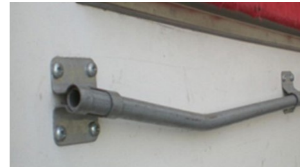
Bekleding en stangen: Stangen en bekleding vervormd, reparatie nog economisch verantwoord
