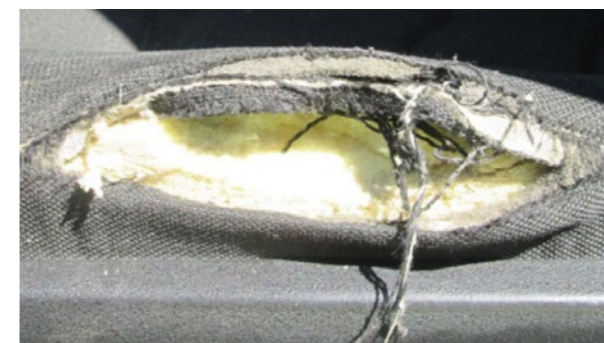
Opvulling ontbreekt of gebroken frame
