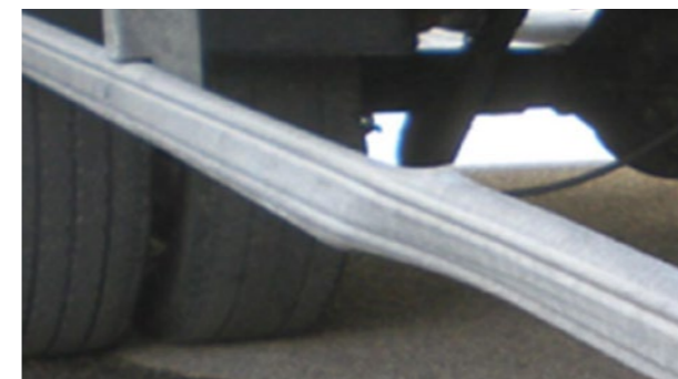
Fietsenrekken: Vervorming niet economisch verantwoord te repareren
