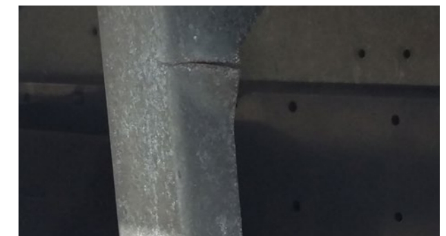
Fietsenrekken: Vervorming niet economisch verantwoord te repareren
