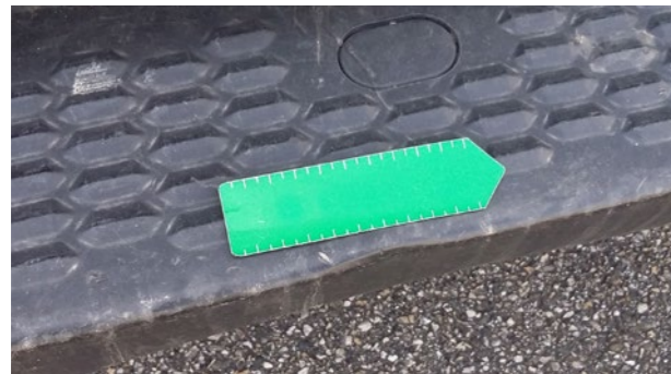
Treepanken achter: Lichte vervorming
