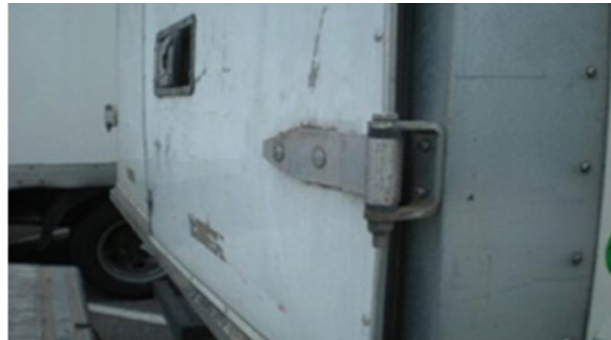
Zij- en achterdeuren: Deuren gebogen bij bevestigingspunten voor scharnieren, geperforeerd of niet meer economisch verantwoord te repareren
